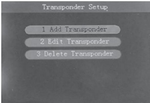
Navigieren Sie in den Untermenüs mit den Richtungstasten und geben die gewünschten Parameter ein bzw. bearbeiten diese. Um einen Satelliten zu löschen, wählen Sie den zu löschenden Satelliten aus und bestätigen das Löschen mit der **OK Taste**.
