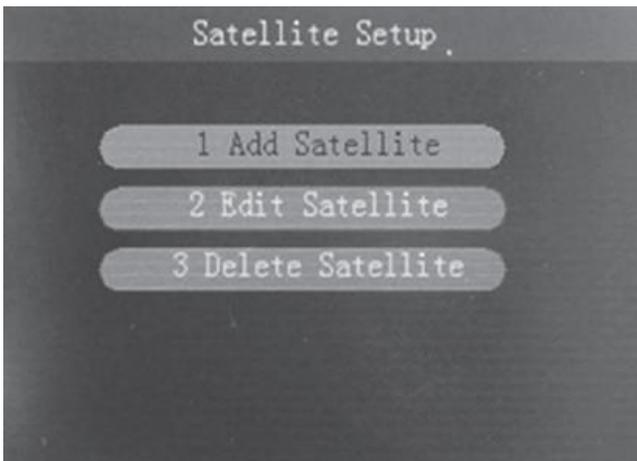
Navigieren Sie in den Untermenüs mit den Richtungstasten und geben die gewünschten Parameter ein bzw. bearbeiten diese. Um einen Satelliten zu löschen, wählen Sie den zu löschenden Satelliten aus und bestätigen das Löschen mit der **OK Taste**.
